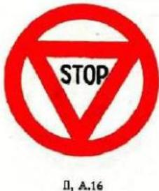
3) Der Durchmesser beträgt bei diesem Zeichen [Signal] im Normalformat wenigstens 0,90 m, im Kleinformat mindestens 0,60 m.
