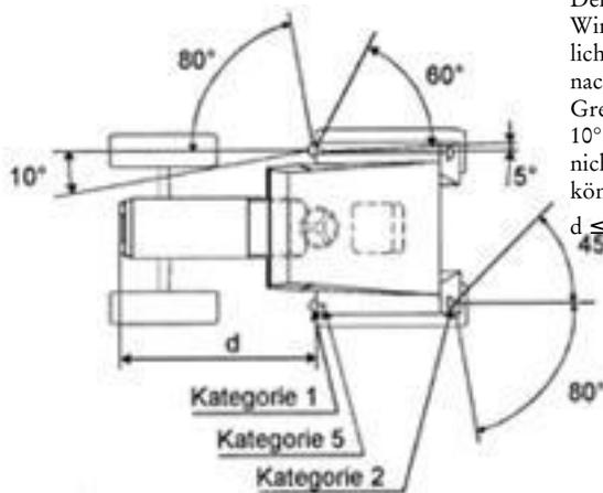
Der Wert von 5° für den toten Winkel der Sichtbarkeit des seitlichen Zusatz-Richtungsblinkers nach hinten ist eine obere Grenze. Dieser Wert kann auf 10° erhöht werden, wenn 5° nicht eingehalten werden können.
