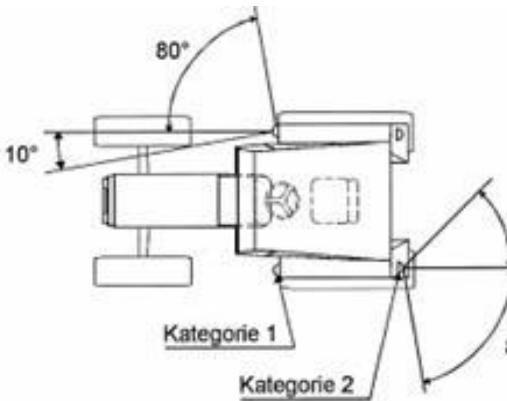
Der Wert von  $10^\circ$  für die Sichtbarkeit der vorderen Richtungsblinker nach innen kann bei Fahrzeugen mit einer Breite über alles von nicht mehr als 1.40 m auf  $3^\circ$  verringert werden.
