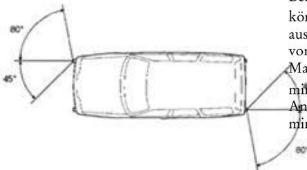
Bei Fahrzeugen der Klassen M1 und N1 können die horizontalen Sichtwinkel nach aussen auf  $45^\circ$  reduziert werden, wenn vorne bzw. hinten ergänzende seitliche Markierlichter mit einer Leuchtfläche von mindestens je  $12,5 \text{ cm}^2$  angebracht sind. Bei Anhängern muss der innere Sichtwinkel mindestens  $5^\circ$  betragen.
